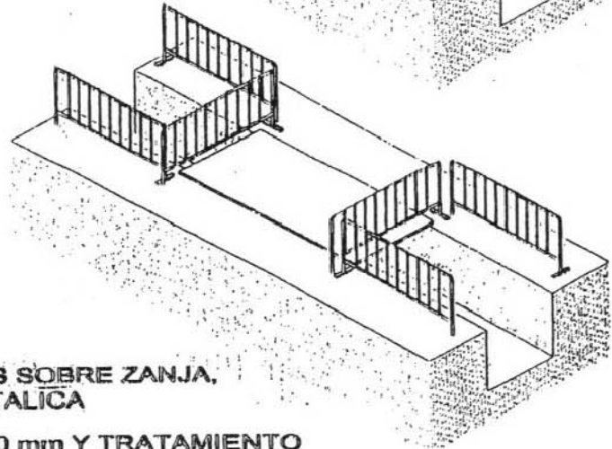
PASO PEATONES SOBRE ZANJA, CON PASARELA
